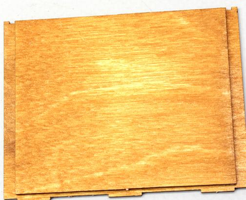
Danach leimen Sie die geschlossene Platte dahinter. Achten Sie darauf, dass die Platte genau mittig sitzt. Die drei Zapfen müssen später in die Grundplatte gesteckt werden und die kleinen Aussparungen oben halten die Vorder- und die Rückwand. Die hinterleimte Platte darf nirgendwo stören.
