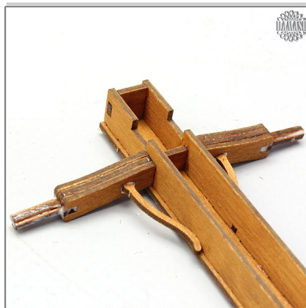
Der fertige Längsholm soll später den Wagenaufbau tragen. Dazu bekommt er an dieser Stelle noch zwei Querträger. Jeder dieser Querträger besteht aus vier Einzelteilen. Lösen Sie die folgenden Teile aus der Trägerplatte aus.
